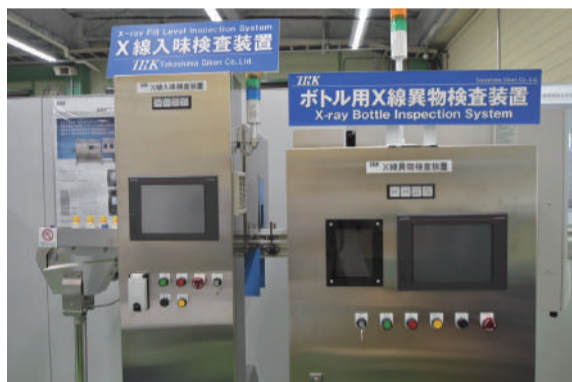
▲飲料の液面の高さや異物を検査する装置
